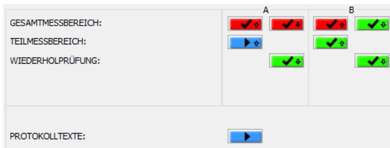
Für jeden Prüfschritt stellt das Programm einen farbigen Schalter dar. Dieser entspricht dem aktuellen Prüfergebnis, kann aber auch zum Start / Wiederholen von einem Prüfschritt verwendet werden. Die Pfeile symbolisieren die Messung mit „hineingenden“ bzw. „herausgehenden“ Messbolzen. Bei Messmitteln mit 2 unabhängigen Messwerken/Messrichtungen (z.B. Fühlhebelmessgeräte) werden die Prüfschritte von A und B dargestellt.
